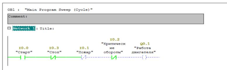
Рисунок 3.4 - Остановка двигателя при пожаре
